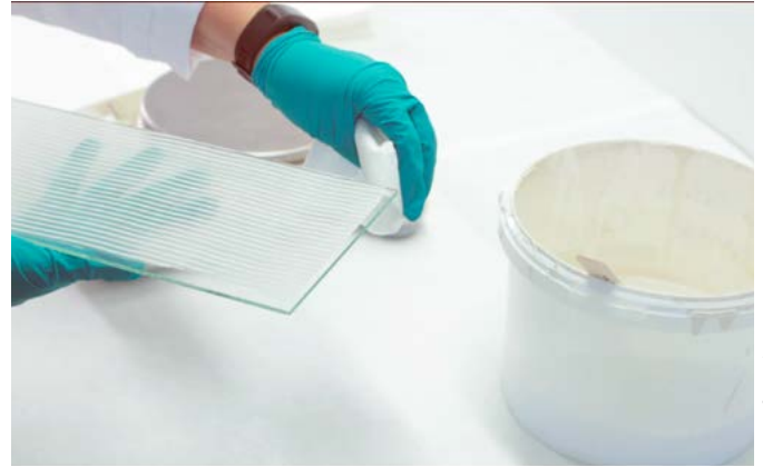
Beim Prüfkörper handelt es sich um die zu untersuchende und korrekt vorbereitete Probe: zum Beispiel die Platte, auf der ein Klebstoff oder eine Spachtelmasse aufgetragen ist.
