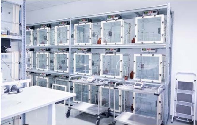
Die GEV gibt vor, dass bei den Emicode-Tests in den Prüfkammern 23 °C Temperatur und 50 % Luftfeuchte herrschen müssen – wie hier im eco-Institut.
